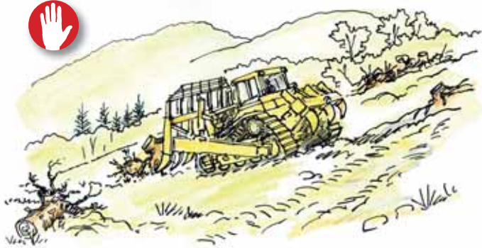
Mauvaise pratique - L'arrachage des souches favorise l'érosion des sols
